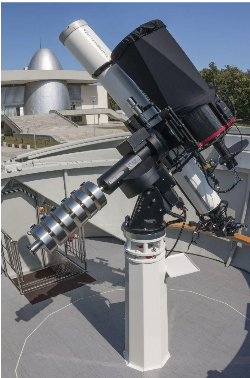
Рисунок 4 — Телескоп TEC APO 250VT f/8.8 Fluorite Apochromat
