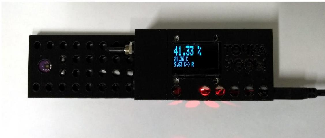
Рисунок 7 – измерительный прибор «Точка росы»
